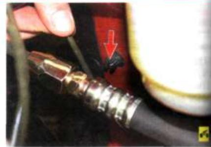
8. ...извлеките трубку из держателя на брызговике и снимите трубку.
