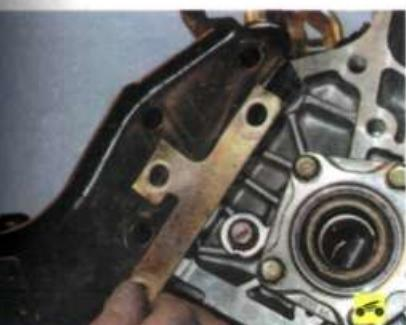
6. ...снимите стопорную пластину...
