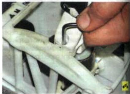
6. Установите рычаг переключения передач в положение выбора I или II передачи и совместив отверстия в упорной втулке рычага переключения передач и крышки механизма переключения передач, вставив в совмещенные отверстия второй стержень диаметром 5,0 мм.
