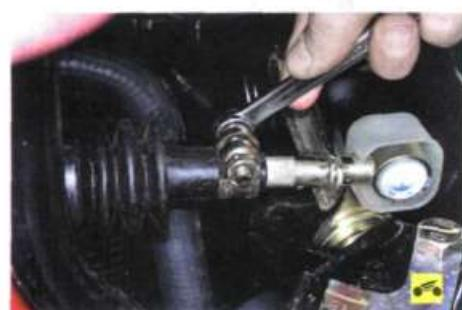
1. В моторном отсеке ослабьте гайку болта клеммового соединения наконечника рычага и тяги переключения передач.
