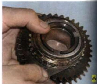
– при установке блокирующего кольца синхронизатора на конус соответствующей шестерни зазор между торцами кольца из чатого венца шестерни должен быть не менее 1 мм. В противном случае блокирующее кольцо необходимо заменить.
