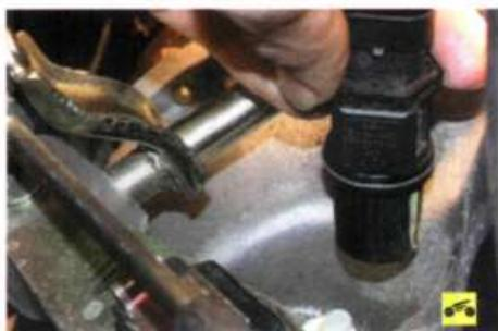
9. Отверните от привода спидометра датчик скорости автомобиля.
