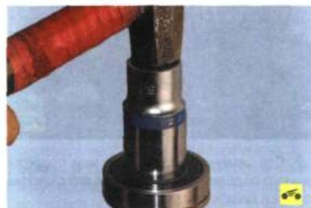
8. Собирайте первичный вал в порядке, обратном разборке. Задний подшипник напрессовывайте на вал, прикладывая усилие только к внутреннему кольцу, иначе подшипник будет поврежден.
