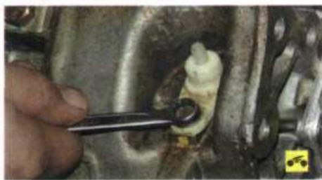
10. Выверните болт крепления и снимите привод спидометра.
