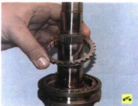
23. ...и блокирующее кольцо синхронизатора III передачи.
