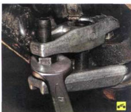
5. Снимите пружинный фиксатор гайки пальца шаровой опоры, отверните гайку и выпрессуйте палец съемником (см. «Замена шаровой опоры амортизаторной стойки», с. 166).
