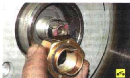
3. Снимите колесо, отверните гайку ступицы...
