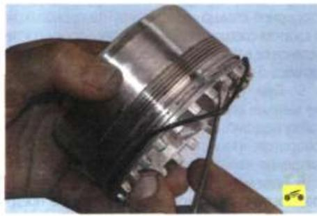
65. Снимите с гайки уплотнительное кольцо.
