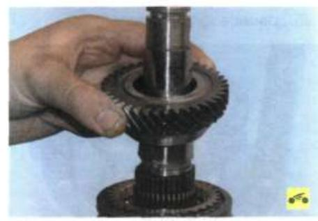
21. Снимите с вала ведомую шестерню III передач...
