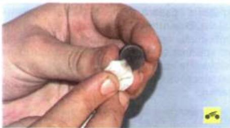
79. Очистите магнит от частиц износа деталей. Если на магните появились трещины или его магнитные свойства ослаблены, замените магнит.
