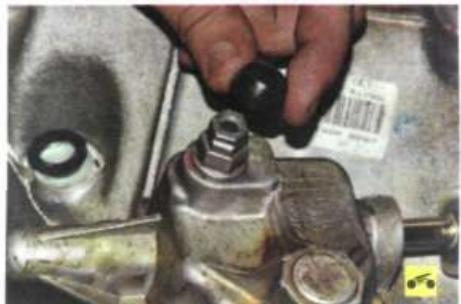
12. Снимите защитный колпачок...
