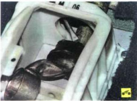
10. Протолкните отверткой внутрь корпуса рычага резинопластмассовую направляющую втулку и продвиньте ее вдоль по валу.
