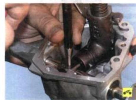
1. Выбейте штифт крепления шарового рычага к валу переключения передач...
