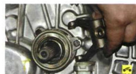
4. Снимите вилку выключения сцепления.
