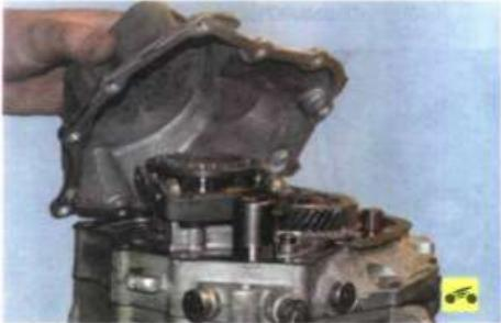
17. ...затем снимите крышку...
