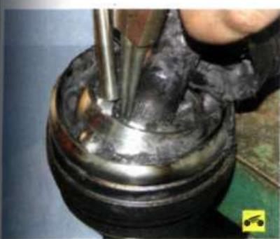
7. Разожмите стопорное кольцо съемником стопорных колец и сбейте обойму с вала молотком через бородок.
