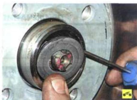
4. ...и снимите упорную шайбу, поддев отверткой.
