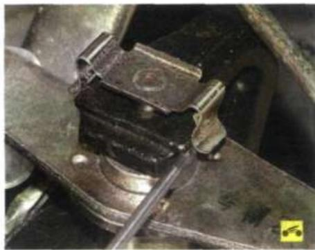
1. Для замены втулок шарнира рычага переключения передач отожмите отверткой фиксаторы оси рычага...
