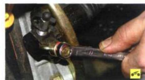
1. Выверните болт-штуцер и отсоедините от рабочего цилиндра шланг. Заглушите шланг, чтобы не вытекала тормозная жидкость.
