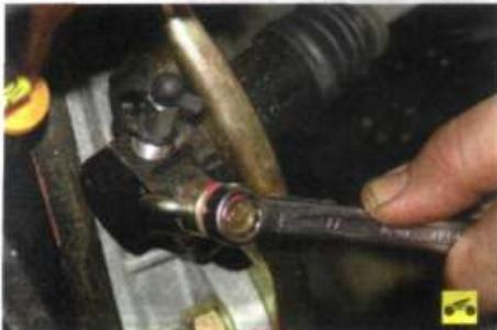
4. Выверните болт-штуцер и снимите шланг...
