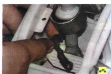
7. Отстегните от рычага фиксатор оси...
