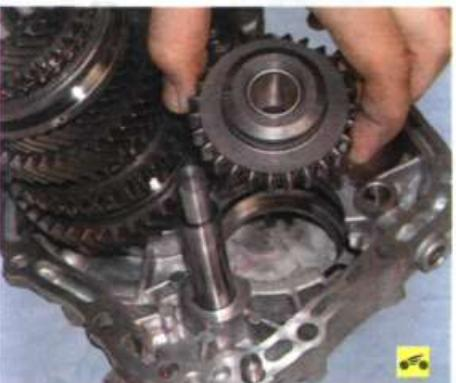
54. Снимите промежуточную шестерню заднего хода.
