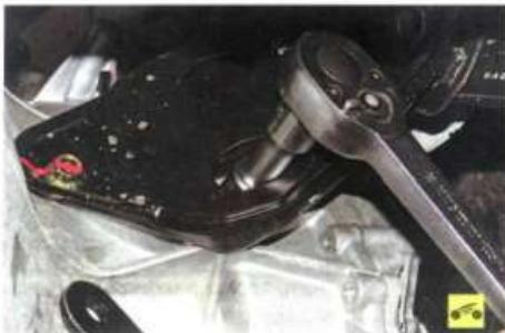
12. Установите опору под коробку передач и выверните три болта крепления кронштейна левой передней опоры подвески силового агрегата к коробке передач.
