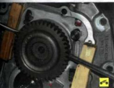
35. ...и двумя отвертками спрессуйте шестерню, используя в качестве прокладок деревянные бруски.
