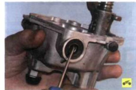
4. Поддев отверткой, извлеките из гнезда крышки сальник вала переключения.
