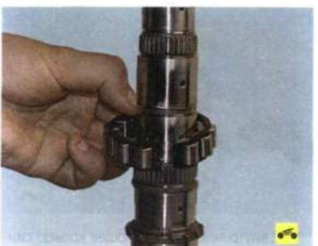
31. ...и задний роликовый подшипник вторичного вала.
