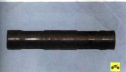
15. Мелкие неровности на шейках оси сателлитов удалите мелкозернистой наждачной бумагой. При наволакивании на шейки металла сателлитов или при их одностороннем износе замените ось.
