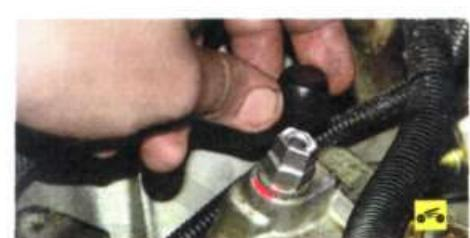
4. Снимите защитный колпачок с пробки отверстия для заливки масла, расположенной сверху на промежуточном картере коробки передач.
