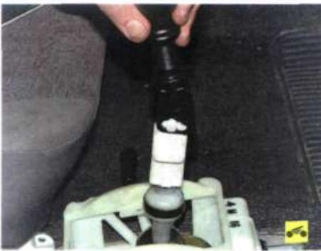
9. Потянув вверх, снимите рычаг переключения передач.
