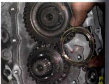
29. Снимите блокирующее кольцо синхронизатора...
