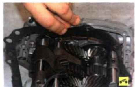
43. Снимите прокладку промежуточного картера.
