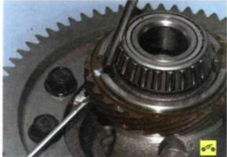
1. При сильном износе зубьев шестерни привода спидометра замените шестерню. Для этого разведите отверткой концы стопорного кольца и одновременно второй отверткой сдвиньте по цапфе коробки дифференциала шестерню вместе с кольцом.
