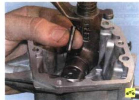
2. ...и извлеките штифт из крышки механизма переключения передач.
