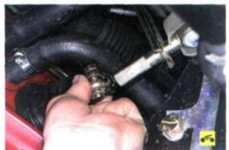
6. ...и разъедините тягу и наконечник рычага переключения передач.
