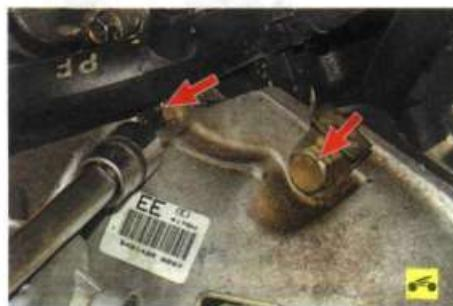
14. Выверните два болта крепления коробки к блоку цилиндров под водораспределительной трубой...
