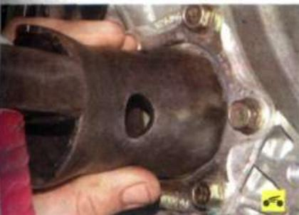
3. Смажьте рабочую кромку нового сальника трансмиссионным маслом и запрессуйте его оправкой подходящего диаметра рабочей кромкой внутрь коробки.
