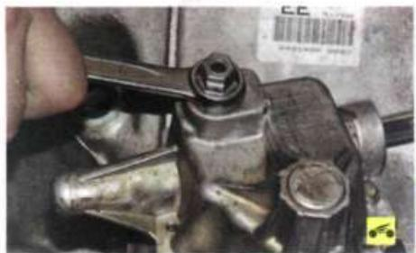
13. ...и выверните пробку отверстия для заливки масла.
