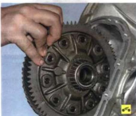
70. Извлеките из картера коробки передач дифференциал в сборе.
