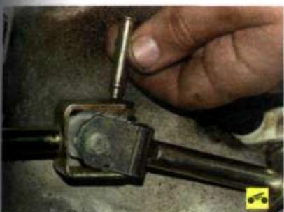
3. ...и извлеките ось шарнира привода переключения передач. Разъедините вилки шарнира.
