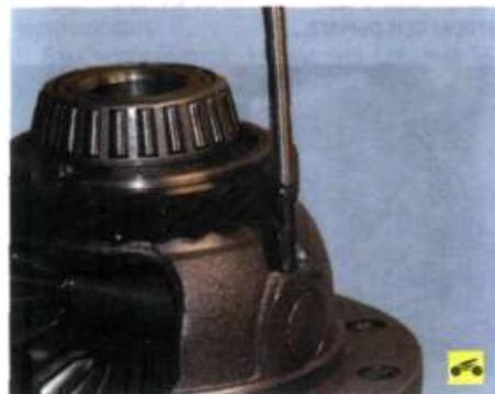
– фиксирующий штифт оси сателлитов запрессовывайте в отверстие коробки дифференциала с той стороны, в которую его выбивали;
