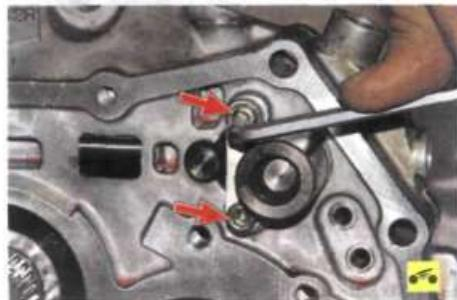
40. Выверните два винта крепления фиксирующего штифта...
