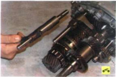
49. Снимите поводок со штоком включения V передачи.
