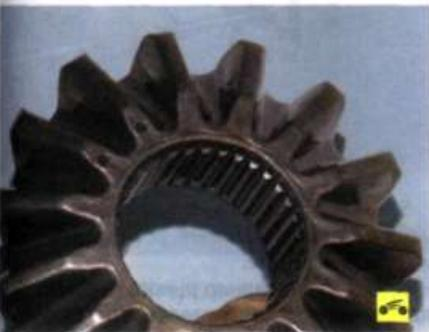
12. ...шилицы и зубья полуосевых шестерен. При сильном износе рабочих поверхностей, шлицев и зубьев, выкрашивании зубьев замените шестерни дифференциала.
