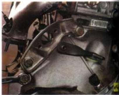
18. ...и рядом с проушиной картера коробки передач для крепления кронштейна рабочего цилиндра сцепления.
