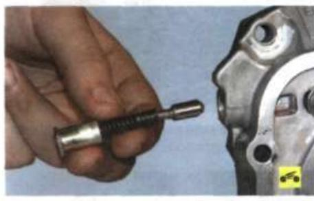
39. ...отличается от двух других. После выпрессовки пробок извлеките из гнезд промежуточного картера пружины и фиксаторы штоков...
