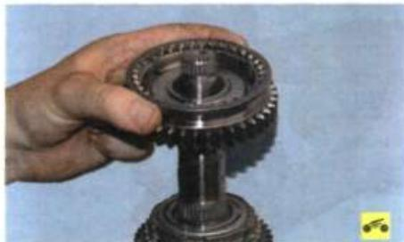
12. Спрессуйте со шлицев вала синхронизатор I и II передач вместе с ведомой шестерней II передачи, прикладывая усилие к торцу шестерни...
