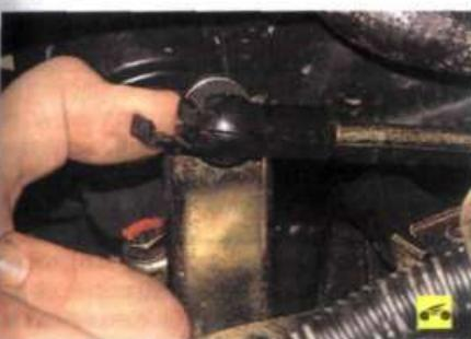
12. Отожмите пластмассовый фиксатор шарнира...
