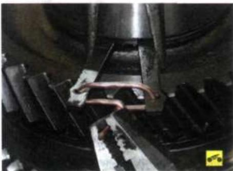
4. Перед установкой вторичного вала в промежуточный картер сожмите круглогубцами стопорное кольцо и зафиксируйте проволокой в скотом состоянии. Снимите проволоку после установки вала в картер, убедившись, что кольцо вошло в проточки картера без перекосов.
