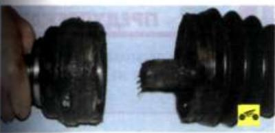
8. Снимите наружный шарнир со шлицев вала.
