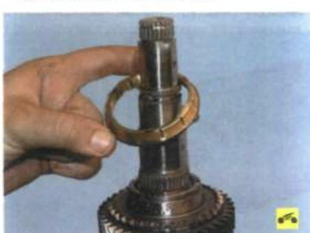
16. ...внутреннее блокирующее кольцо синхронизатора II передач...
