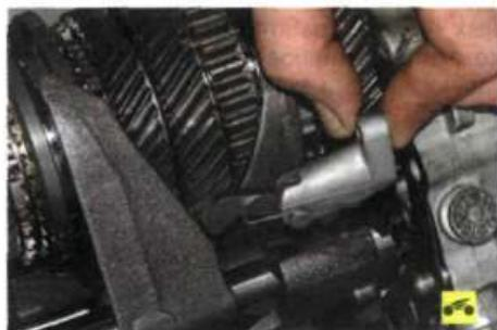
37. ...установите штоки вилок последовательно в положение II, V и III передач и снимите кронштейн в сборе с собачкой.
