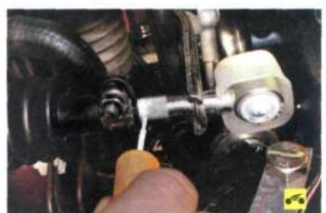
4. Пометьте любым способом (например, краской) взаимное расположение тяги и наконечника рычага переключения передач, чтобы сохранить регулировку привода при обратной установке коробки.
