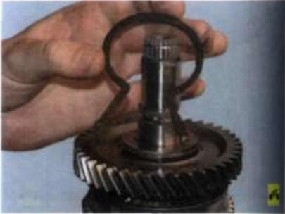
3. Снимите, скав усики, пружинное стопорное кольцо...
