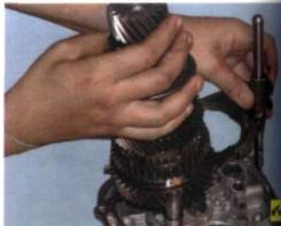
55. Извлеките из картера хвостовик первичного вала и снимите вал в сборе, а также шток и вилку переключения I и II передач.
