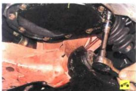
1. Установите под коробку передач емкость для слива масла, выверните болты крепления нижней крышки коробки передач...
