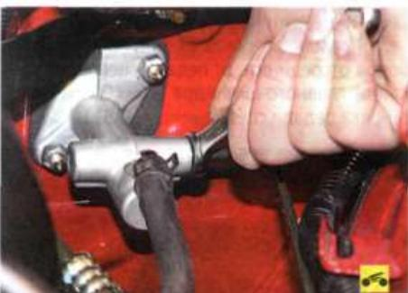
7. Отверните гайку крепления трубы к главному цилиндру привода выключения сцепления...
