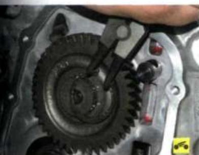
34. Снимите стопорное кольцо ведущей шестерни V передачи...
