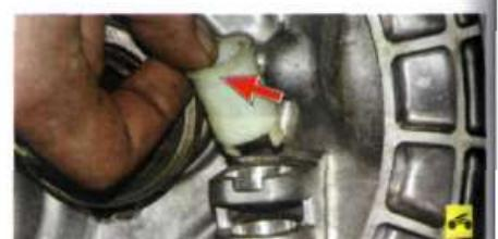
6. ...и нижнюю втулки вала выключения сцепления.
