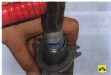
6. Оправкой подходящего диаметра (например, торцовой головкой «на 26») выпрессуйте сальник...
