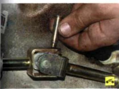
8. ...и извлеките ось шарнира привода переключения передач. Разъедините вилки шарнира.
