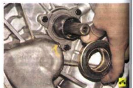
7. Снимите подшипник выключения сцепления с направляющей втулки.
