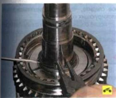
10. Разжав съемником и поддев отверткой, снимите стопорное кольцо...
