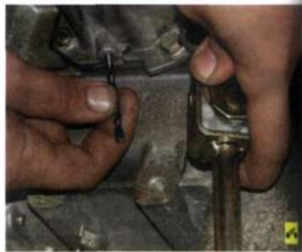
4. Поверните вал переключения передач, чтобы стержень диаметром 5,0 мм (например, хвостовик подходящего сверла, вставленный в отверстие крышки 2 (рис. 6.5), попал в установочное отверстие регулятора 4.
