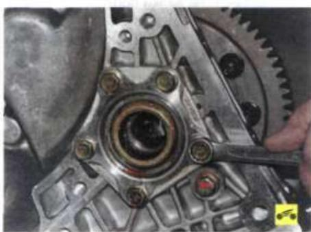
69. Выверните пять болтов крепления крышки правого подшипника дифференциала, снимите крышку, снимите с нее уплотнительное кольцо, затем выпрессуйте из крышки сальник и при необходимости наружное кольцо подшипника так же, как выпрессовывали их из регулировочной гайки.
