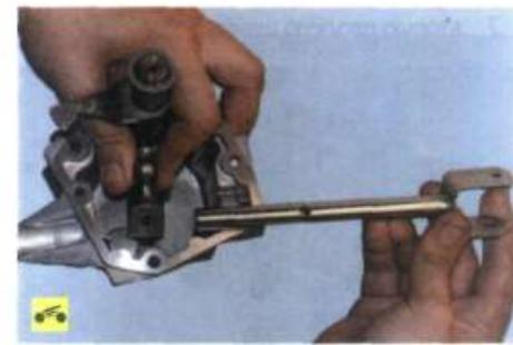
3. Выньте вал переключения из отверстий крышки и извлеките из крышки шаровой рычаг.
