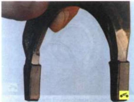
75. Проверьте состояние вилок переключения передач. Если вилки погнуты либо изношены лапки, замените эти детали.
