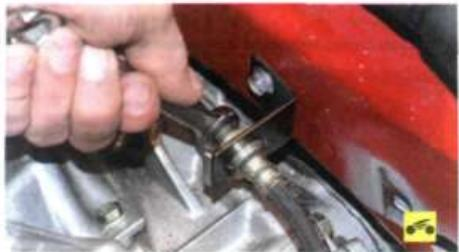
1. Отверните гайку крепления трубы к наконечнику шланга и отведите трубку в сторону.
