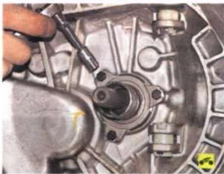
4. Сальник первичного вала заменяют на снятой с автомобиля коробке передач после снятия подшипника выключения сцепления (см. «Замена вилки и подшипника выключения сцепления», с. 136). Выверните три болта крепления направляющей втулки подшипника выключения сцепления...
