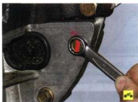
16. ...и четыре болта (под ключ «на 14») крепления масляного картера к картеру коробки передач.
