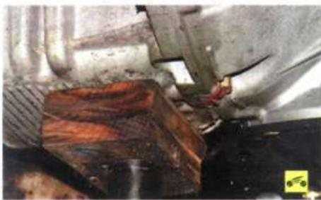
11. Установите опору под масляный картер двигателя, используя отрезок доски в качестве прокладки.
