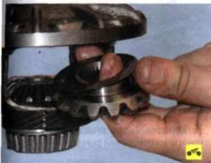
10. ...и полуосевые шестерни вместе с опорными шайбами.
