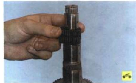
18. Снимите игольчатый подшипник ведомой шестерни II передачи.
