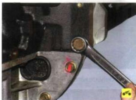
15. ...болт, расположенный возле масляного фильтра...
