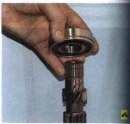
2. ...и снимите подшипник с вала.
