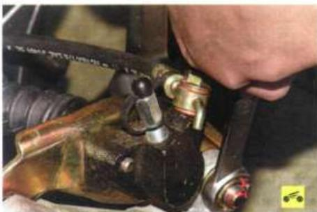
9. Отверните две гайки болтов крепления кронштейна рабочего цилиндра сцепления, удерживая нижний болт от проворачивания вторым ключом.
