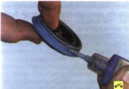
3. ...и устанавливайте сальники с применением анаэробного фиксатора резьбы.
