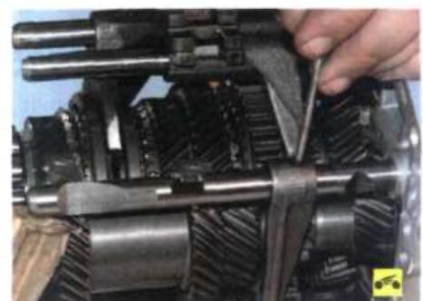
44. Оперев свободный конец штока на деревянный брускок, выбейте бородком штифт крепления вилки включения промежуточной шестерни заднего хода...
