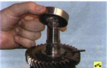
2. ...и снимите задний подшипник.
