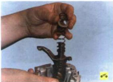
6. ...и снимите с оси переключателя передач стопорное кольцо, плоскую шайбу, пружину...
