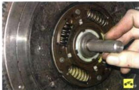
4. При установке сцепления сначала установите с помощью оправки (см. рис. 6.2) ведомый диск, затем кожух нажимного диска и вверните болты крепления кожуха к маховику. Болты вворачивайте равномерно: по одному обороту ключа каждый, переходя от болта к болту по диаметру. Момент затяжки болтов 15 Н·м.
