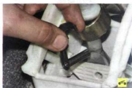
8. ...и снимите ось рычага, извлекая ее из отверстий рычага и кулисы.
