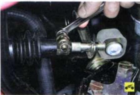
3. В моторном отсеке ослабьте затяжку клеммового соединения привода переключения передач, обеспечив свободное взаимное перемещение наконечника рычага переключения передач и тяги.
