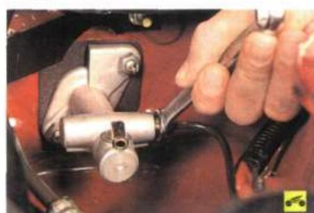
5. Отверните гайку крепления трубки гидропривода выключения сцепления к главному цилинду...
