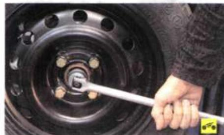
1. Ослабьте затяжку гайки ступицы переднего колеса.
