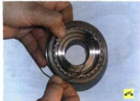
3. ...снимите две пружины.
