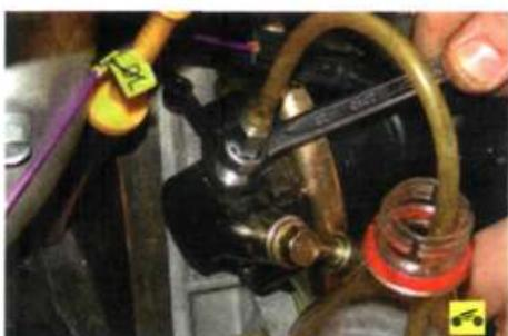
3. Наденьте на клапан шланг и опустите его конец в емкость с небольшим количеством тормозной жидкости. Попросите помощника нажать 4–5 раз на педаль сцепления с интервалами 2–3 с, а затем удерживать ее нажатой. Выверните клапан на 3/4 оборота. Из шланга в емкость будет вытекать жидкость с пузырьками воздуха.
