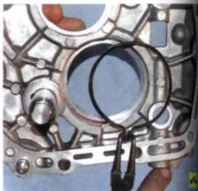
56. Съемником извлеките из проточки промежуточного картера стопорное кольцо шипника первичного вала.
