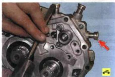
38. Молотком через зубило с притупленным жалом выбейте пробки фиксаторов штоков вилок переключения передач. Обратите внимание на то, что фиксатор, помеченный стрелкой...
