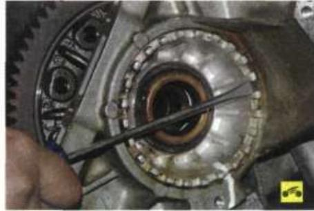
64. ...и, подсчитывая число оборотов, выверните регулировочную гайку отверткой, как показано на фото.
