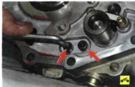
36. Выверните два болта крепления кронштейна собачки...
