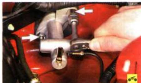
8. Отверните две гайки крепления главного цилиндра привода выключения сцепления к кузову...
