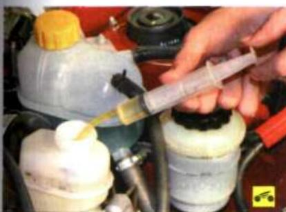
1. Отверните пробку бачка и откачивайте (например, большим медицинским шприцем) тормозную жидкость из секции бачка главного тормозного цилиндра, питающей гидропривод выключения сцепления.
