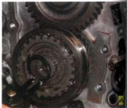
26. Специальным съемником снимите порное кольцо синхронизатора V передач.
