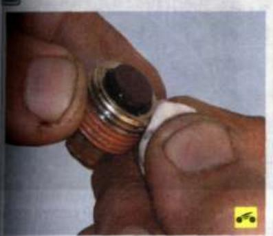
В пробке установлен магнит для сбора металлических продуктов износа, очистите его перед установкой пробки.
