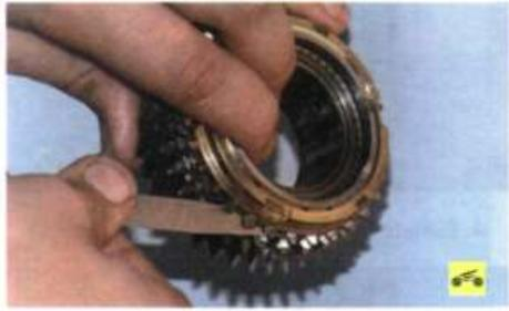
11. При установке блокирующего кольца на конус соответствующей шестерни зазор между торцами венцов кольца и шестерни должен быть не менее 1 мм, в противном случае блокирующее кольцо замените.
