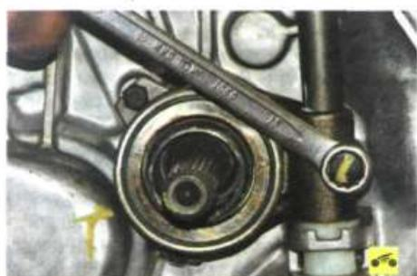
2. Выверните болт крепления вилки к валу выключения сцепления...
