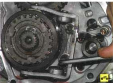
23. Выверните два болта крепления кронштейна вилки включения V передачи...
